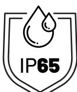
Este grado de protección corresponde a una resistencia al polvo y al agua (chorros de agua), permitiendo el uso del producto en exteriores. Sin embargo, este grado de protección no protege contra la inmersión del dispositivo.
