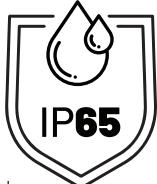
Ce degré de protection correspond à une résistance aux poussières ainsi qu'à l'eau (jets d'eau) permettant l'utilisation du produit en extérieur. Cependant ce degré de protection ne protège pas contre l'immersion de l'appareil.
