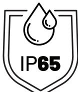
Dieser Schutzgrad entspricht einer Resistenz gegen Staub und Wasser (Wasserstrahlen), was den Einsatz des Produkts im Freien ermöglicht. Allerdings schützt dieser Schutzgrad nicht vor dem Eintauchen des Geräts in Wasser.
