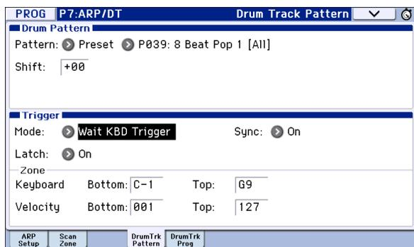
4. Si "Trigger Mode" est réglé sur "Wait KBD Trigger", vous pouvez également régler "Latch". "Latch" détermine si le pattern Drum Track doit se poursuivre après le relâchement des touches du clavier.
