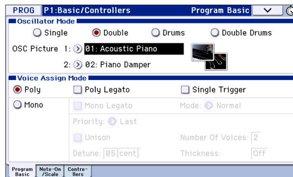
En mode **Single** (programme simple), un seul oscillateur est utilisé; le mode **Double** (programme double), en revanche, exploite deux oscillateurs.
