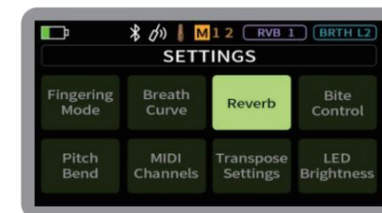
Outre le réglage dans le menu Settings, il existe un raccourci : il suffit d'appuyer simultanément sur la touche [Octave supérieure] et sur le bouton [TRANSPOSE] pour affiner le niveau de réverbération.
