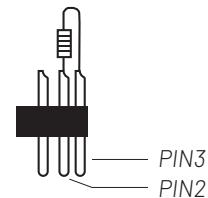
En utilisation professionnelle, la norme DMX512 impose la présence d'un «bouchon DMX» sur le dernier appareil DMX de la chaîne afin de finaliser correctement la boucle de signal. Ce bouchon est constitué d'une résistance de 120 ohms placée entre la broche 2 et la broche 3 du connecteur XLR.
