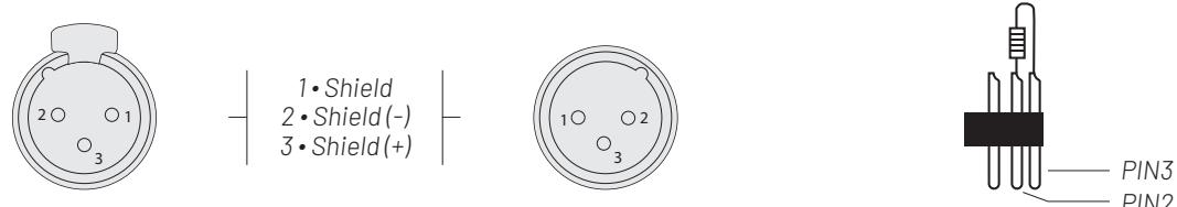
En uso profesional, la norma DMX512 requiere la presencia de un 'tapón DMX' en el último dispositivo DMX de la cadena para finalizar correctamente el bucle de señal. Este tapón está compuesto por una resistencia de 120 ohmios colocada entre el pin 2 y el pin 3 del conector XLR.
