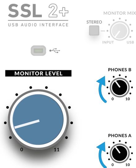
**ATTENTION!** Si vous utilisez un microphone et que vous monitorisez l' **INPUT**, faites attention à ne pas tourner vers le haut l'encodeur du **MONITOR LEVEL** car cela peut créer une boucle de larsen si le microphone est proche de vos enceintes. Gardez soit le niveau d'écoute à bas volume ou écoutez avec des écouteurs.
