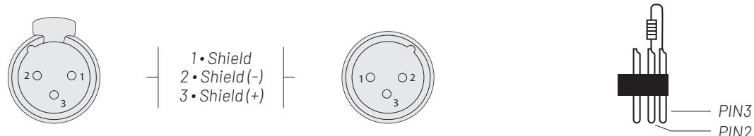
En uso profesional, la norma DMX512 requiere la presencia de un 'tapón DMX' en el último dispositivo DMX de la cadena para finalizar correctamente el bucle de señal. Este tapón está compuesto por una resistencia de 120 ohmios colocada entre el pin 2 y el pin 3 del conector XLR.
