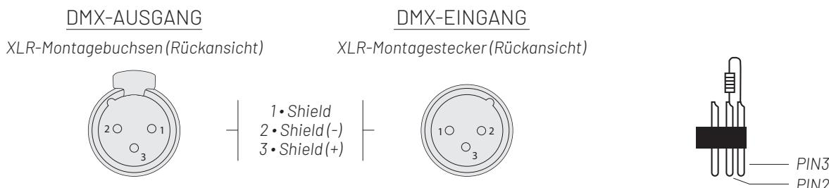
Bei Verwendung des Standard-DMX512-Steuerungssignals muss die Ausgangsschnittstelle des letzten Geräts mit einem DMX-Stecker verbunden sein. Dieser Stecker setzt einen 120-Ohm-Widerstand zwischen den 2 Pins und 3 Pins des "Canon"-Steckers ein. Wie im folgenden Bild gezeigt. Wenn Sie diesen Stecker in die Ausgangsschnittstelle des letzten Geräts stecken, wird dies Interferenzen während des Signalübertragungsprozesses vermeiden.
