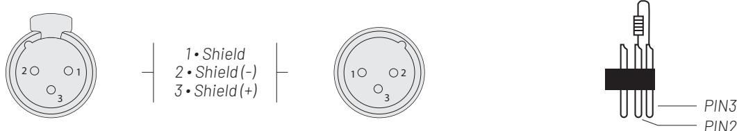
En utilisation professionnelle, la norme DMX512 impose la présence d'un «bouchon DMX» sur le dernier appareil DMX de la chaîne afin de finaliser correctement la boucle de signal. Ce bouchon est constitué d'une résistance de 120 ohms placée entre la broche 2 et la broche 3 du connecteur XLR.
