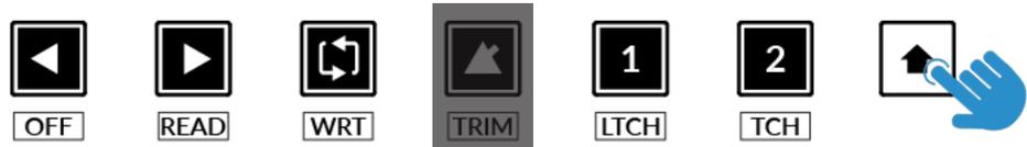
ÉTAPE 2 : Engagez la touche SHIFT KEY pour réutiliser les clés de transport secondaires en clés d'automatisation.
