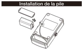
Une pile est fournie avec la pédale. Branchez le cordon d'alimentation à la pile, et insérez celle-ci comme dans l'illustration. Lorsque la pile se décharge, le son change. Dans ce cas, veuillez remplacer la pile par une neuve. La pédale est mise sous tension lorsque vous insérez une fiche dans la prise d'entrée. L'utilisation d'un adaptateur secteur est recommandée car la consommation électrique de la pédale est relativement élevée.
